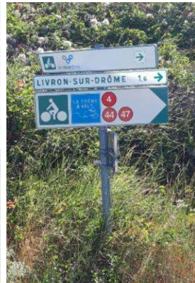
Jalonnement sur voies peu circulées Permet d'indiquer aux cyclistes les routes avec un trafic faible, sur lesquelles le mixte entre voiture/vélo est acceptable.
