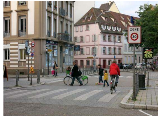
Zone 30 zones de trafic mixte avec une circulation voiture ralentie permettant un confort d'usage de la route pour les cyclistes. C'est une solution utilisée en milieu urbain.
